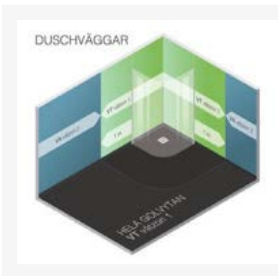
Figur 2 Minimikrav på ytor i våtzone 1 (VT) och våtzone 2 (VA) – Duschväggar om duschväggen är lägre än 2 meter och/eller inte är tätt monterad eller går ned till golv.
